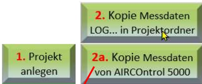
Bei der SD-Karte vom "AIRCO2NTROL 5000" können die Messdaten mit dieser Schaltfläche **in den Projektordner im PC kopiert** werden. Dazu muss die SD-Karte mittels des micro-SD-Karten/USB-Adapters mit dem PC verbunden werden.
